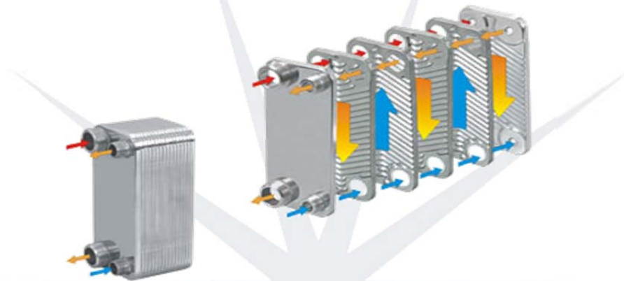
Figura 5: Scambiatore di calore con piastre brasate
